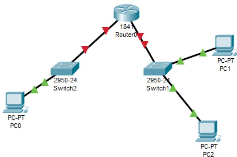
**2. Usmjernik podrazumijevano nema omogućeno korištenje protokola IPv6 i potrebna je konfiguracija istog. Konfigurirajte adresu na lokalnoj vezi za sučelje FastEthernet 0/0 na sljedeći način:**
